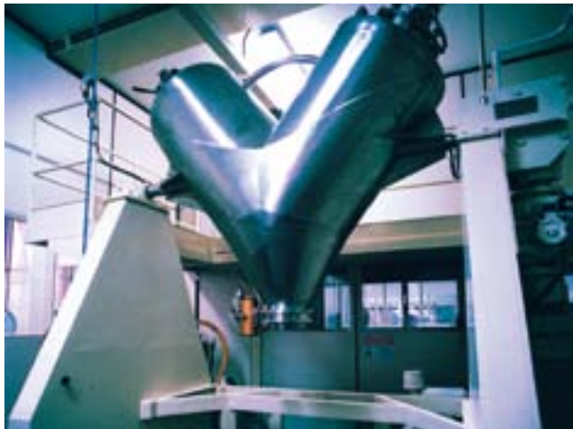
Intercettazione e regolazione pneumatica: scarico mescolatore a "V". Product flow control with air actuated SOLE VALVE on a "V" shaped blender at ZAMBELETTI S.P.A. Baranzate di Bollate, Milano
