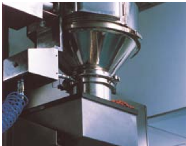
Particolare controllo alimentazione tappi Detail check caps feeding
