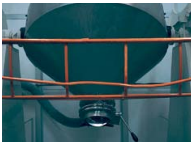
Intercettazione e regolazione scarico miscelatore biconico. Unloading flow control from a cone blender at Bayer S.P.A. Garbagnate, Milano
